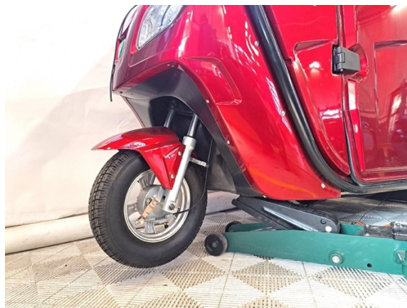
Nosta laitteen etuosa ilmaan.
