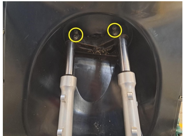
Löysää etujousien kiinnityspulttia. (kiintoavain 12 mm).
