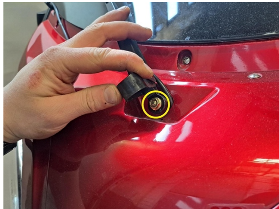
Irrota tuulilasinpyyhkijän kiinnitysmutteri. (hylsy 10 mm).
