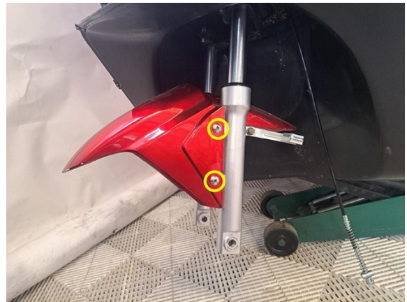
Irrota etulokasuojan kiinnitysruuvit. (ristipäämeisseli ph2)
